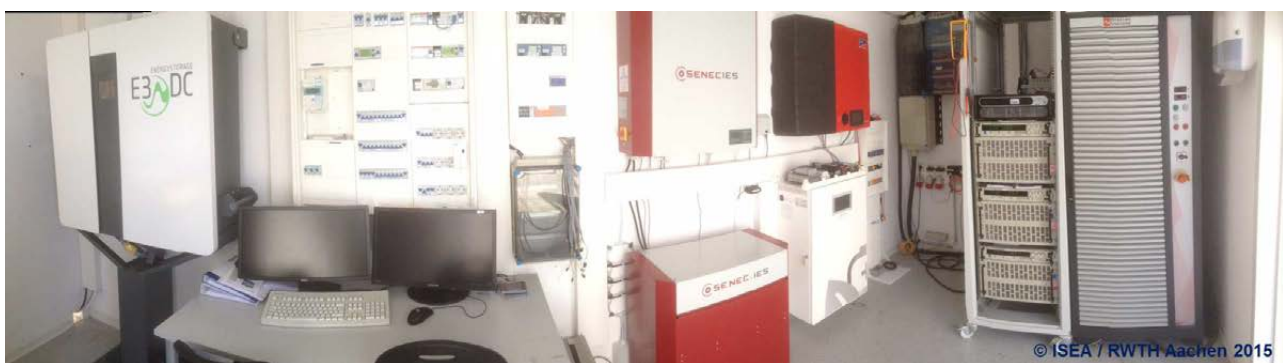
Abbildung 8-12: Prüfstand zur hochauflösenden Vermessung von Solarstromspeichern unter Laborbedingungen
