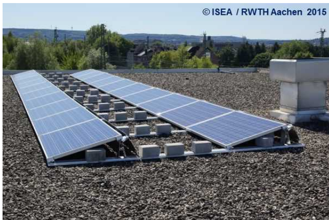
Abbildung 8-10: Institutseigene Solaranlage zum Vermessen von Solarstromspeichern
