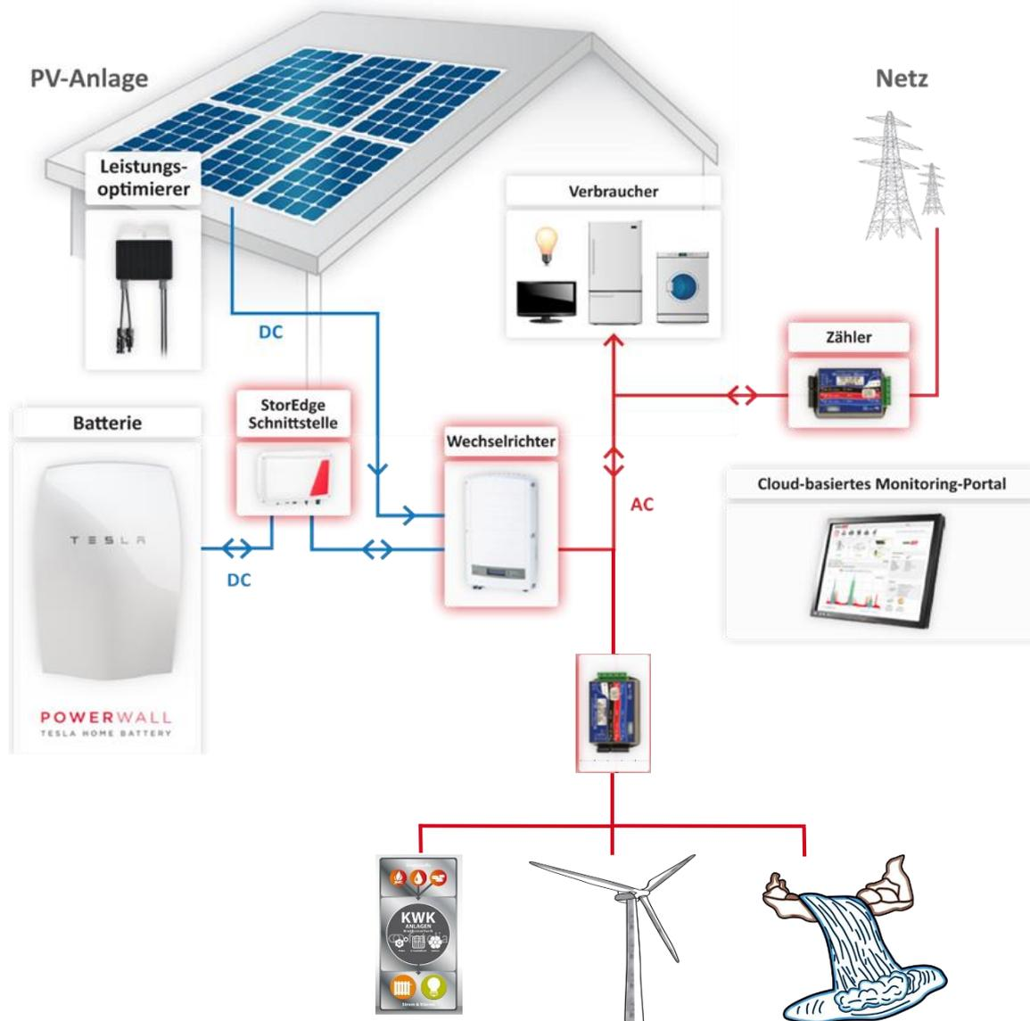
Solange eine Verbindung zum Netz sichergestellt ist und die weiteren Erzeugungsanlagen für den Netzparallelbetrieb zugelassen sind, können diese Erzeuger mit in die SolarEdge StorEdge™ Lösung integriert werden!
